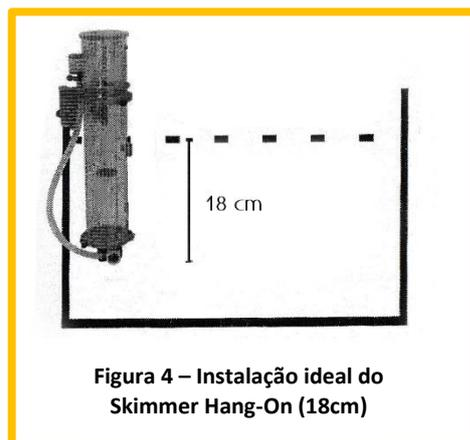
Figura 4 – Instalação ideal do Skimmer Hang-On (18cm)
