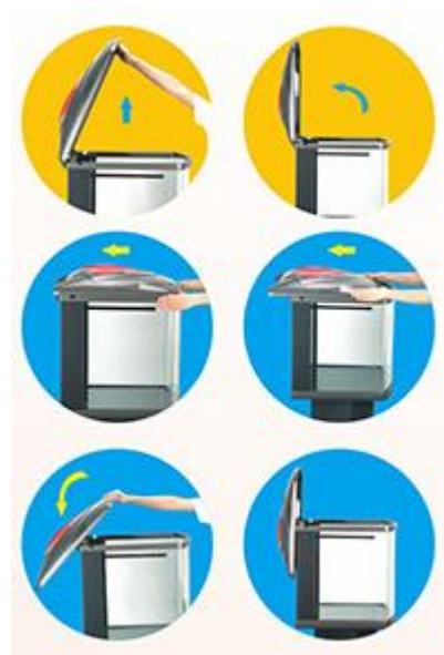
Abertura da Tampa para Manutenção
